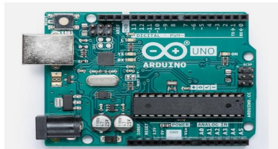
Fig. 2: Genuine Arduino Uno R3
