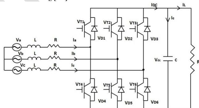
Fig. 1 Circuit diagram of 3- $\phi$  voltage source PWM rectifier
