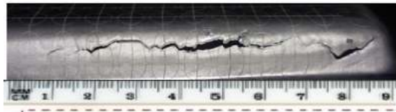
a) Zig Zag Crack
