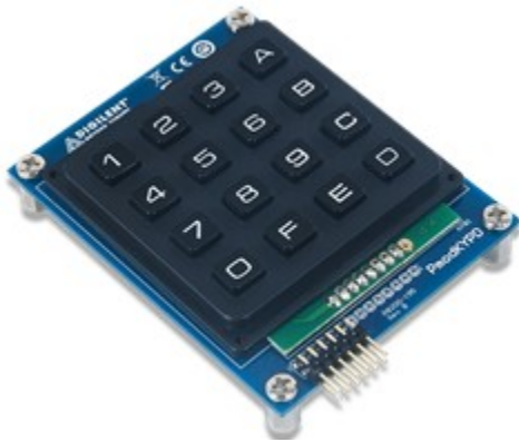
Fig. 3. PmodKYPd 16-button keypad
